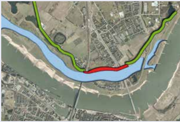
3. Création du bras de décharge de la rivière et des îles allongées au centre de la rivière.
